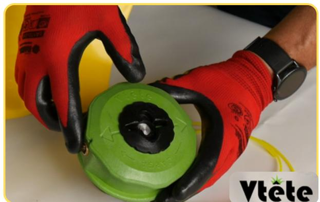
2. Introducir la tanza de nylon por los orificios de la parte superior de cabezal. Una vez que sale por los ojales tirar de la tanza.
