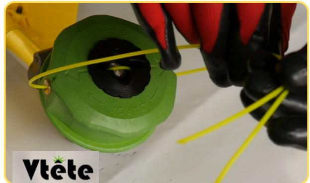
4. Sostenga firmemente el tambor y gire el cabezal en el sentido de las agujas del reloj para cargar la tanza en el cabezal.
